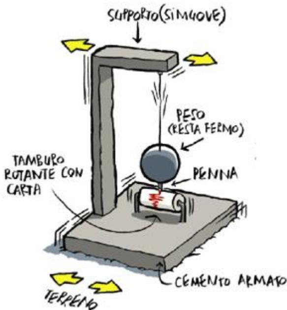
La registrazione di un terremoto si realizza con il **sismografo**; questo strumento è un semplice pendolo che oscilla quando la terra trema. Le oscillazioni vengono registrate su un nastro di carta scorrevole da un pennino collegato al pendolo.
